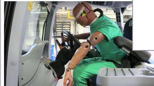
Lors du crash-test, la ceinture de sécurité 2 points a rempli son rôle : maintenir le chauffeur dans le siège pendant le choc.
